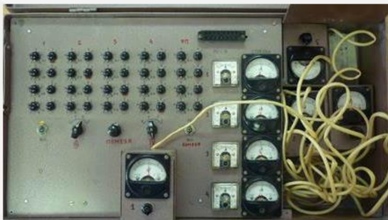
Рис. 1. Внешний вид оригинального прибора «Гомеостат»
